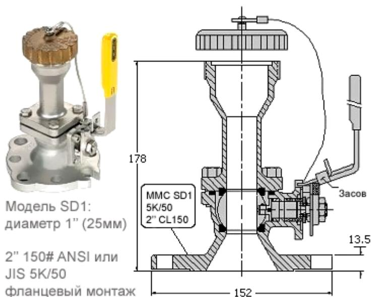
Монтируемый на кормовой части грузового судна, новый клапан звукового определения сухости дна MMC обеспечивает эффективное средство для проверки условий дна резервуара. Клапан позволяет обычному 1-дюймовому отвесу (24,5 мм) опуститься на дно резервуара, чтобы определить, не является ли емкость полностью пустой от груза. Он может быть использован с Пробоотборными рулетками MMC D-2562-1ТВ для звукового определения сухости дна.
